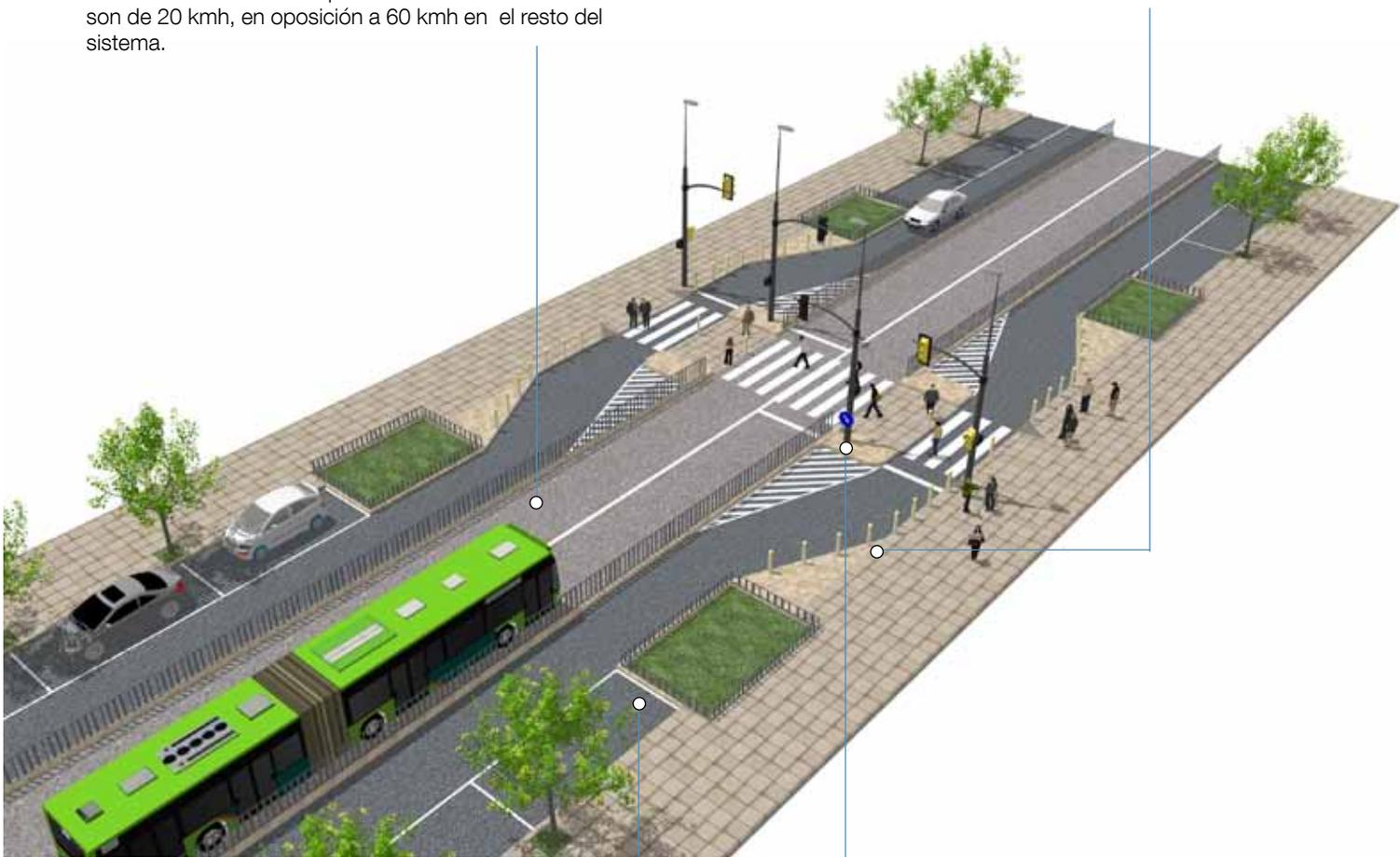
Esta configuración de la calle cuenta con sólo un carril de tráfico mixto por dirección y un espacio de separación entre cada carril y la acera. Este espacio puede ser utilizado como un carril de estacionamiento, áreas con vegetación, ciclovia o para la colocación de barreras para reducir el tráfico cerca de los cruces peatonales en mitad de cuadra..
