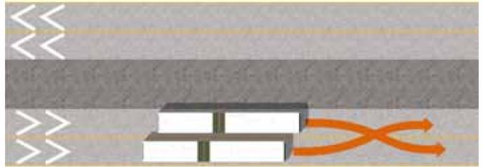
*Choque de baja severidad en una típica estación de TransMilenio: un autobús local dejando la plataforma de la estación choca con un autobús intentando acoplarse a otra plataforma. Estos accidentes suelen ocurrir a baja velocidad, por lo que rara vez resultan en lesiones.*
