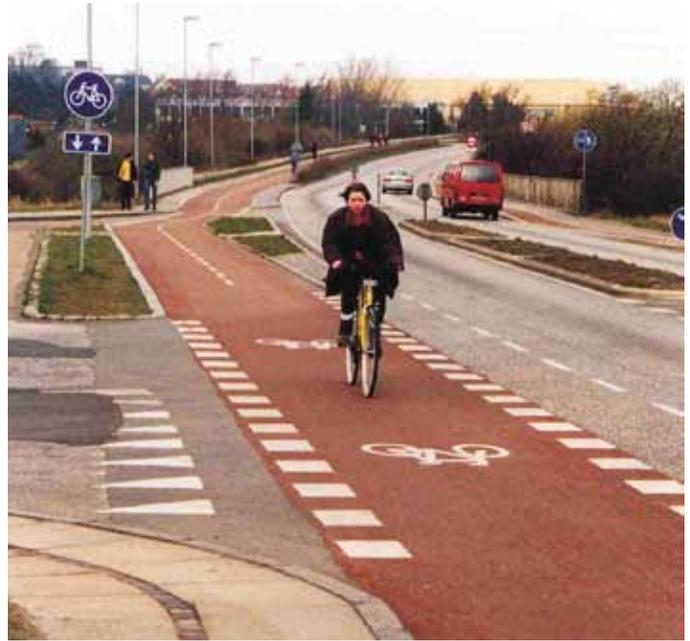
*Ejemplo de señales y marcas de ciclovías. Foto cortesía de Carsten Wass.*
