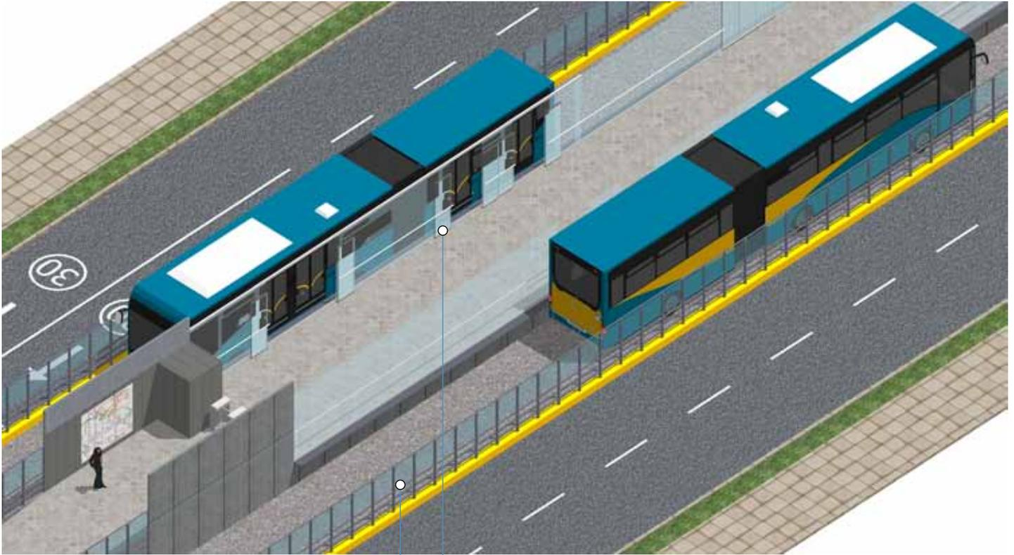
Un componente de seguridad clave en el diseño de la estación consiste en colocar una barrera o valla de protección entre el carril del autobús y los carriles de tráfico. Esto debería ayudar a evitar que los pasajeros intenten caminar a través de los carriles de autobús para entrar o salir de la estación.
